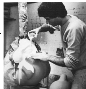
3. Pouring the plaster
